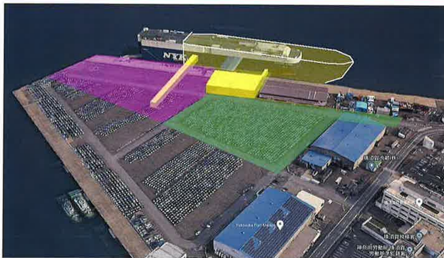
← 現段階の予想図：緑色部分がフェリー専用用地、ピンク色部分が共有地、その他が既存事業者用地 岸壁中央の建物はフェリー乗船ターミナル、その左に伸びるのは車路
