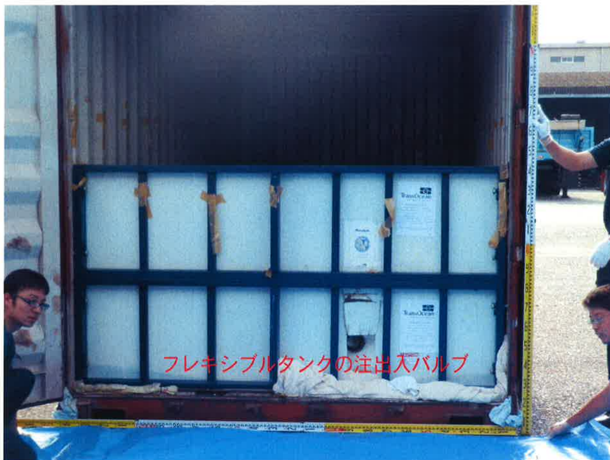
20 フィートコンテナドアのトメ板 下部の穴はフレキシブルバックの液体注入口
