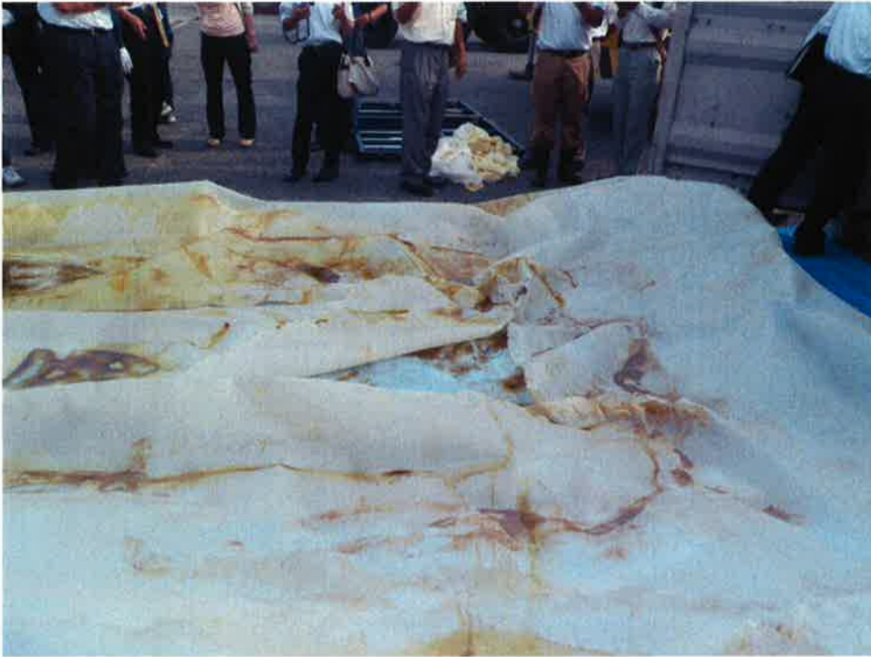
フレキシブルタンク上部が、裂けた部分右側は 20 フィートコンテナの奥側急ブレーキで、水枕状態の袋が前方のコンテナに当たり、衝撃で裂けたと思われます。
